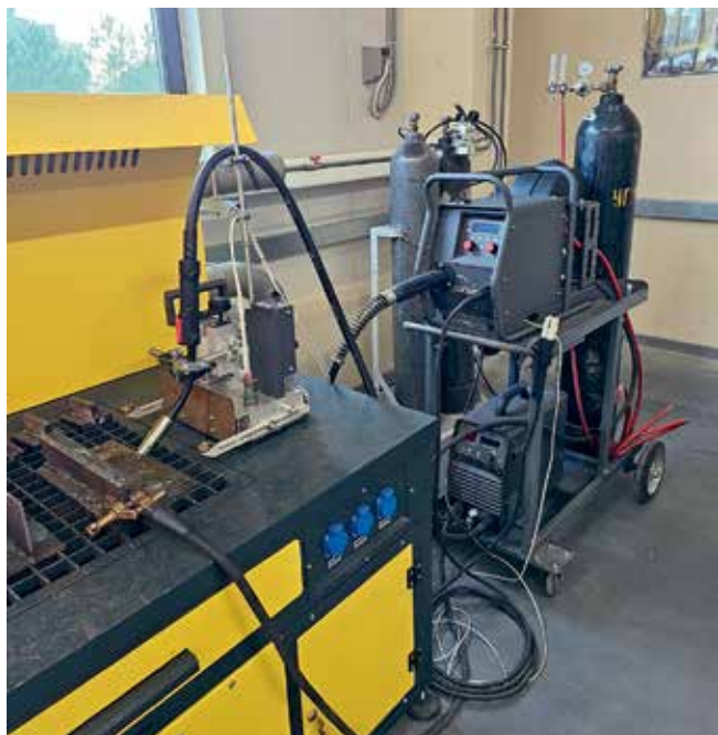
Комплекс автоматической сварки на базе оборудования российского производства. Ведется высокоскоростная цифровая съемка сварочного процесса / Фото: Korabel.ru
