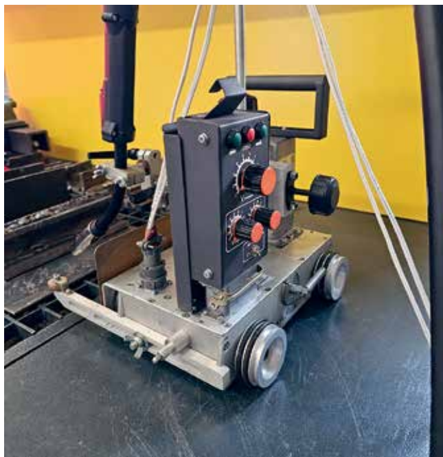
Комплекс автоматической сварки на базе оборудования российского производства. Ведется высокоскоростная цифровая съемка сварочного процесса / Фото: Korabel.ru
