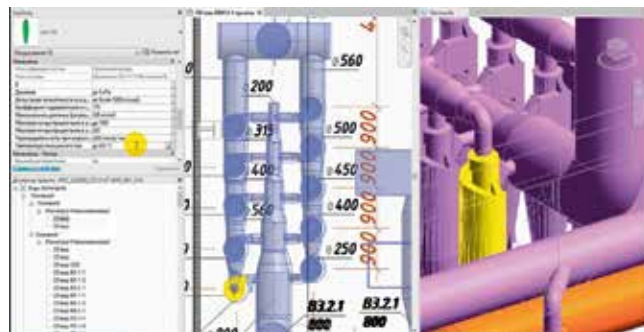
Рис. 5. Доступ к параметрам оборудования из 3D-пространства ЦПИ / Фото: Бюро ESG
