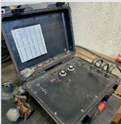
Блок управления (на фото слева), погружной сварочный блок (на центральном фото) и сварочный аппарат (на правом фото), входящие в состав комплекса КОПС-М / Фото: Korabel.ru
