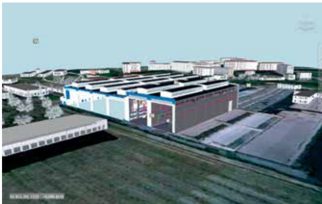
Рис. 1. Размещение трехмерных моделей цехов на цифровом генплане / Фото: Бюро ESG
