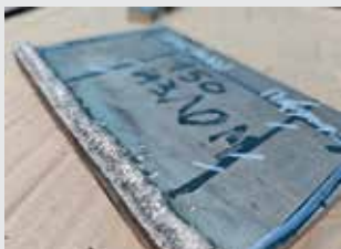
Излом сварного шва выполнен на высоколегированной хромоникелевой стали, предназначенной для строительства водных хранилищ и ремонта бассейнов системы охлаждения на АЭС. В изломе отсутствуют поры и трещины
