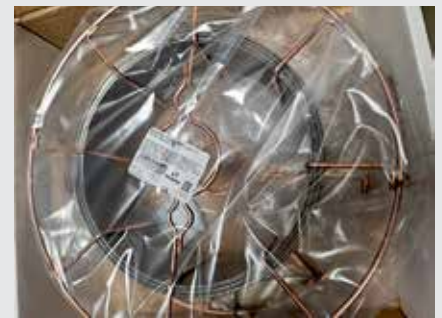
Порошковая проволока ППС-АПЛ2 (слева на верхнем фото) для подводной мокрой сварки на глубинах до 60 м. АПЛ-2 названа в честь ее разработчиков – Антипова И.С., Паршина С.Г. и Левченко А.М.
