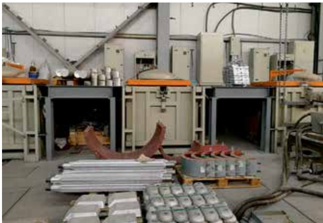
Плавильный участок. Печи плавильные ПП-2000 и протекторы / Фото Китав Прохор и НПО Р.О.С.Антикор
