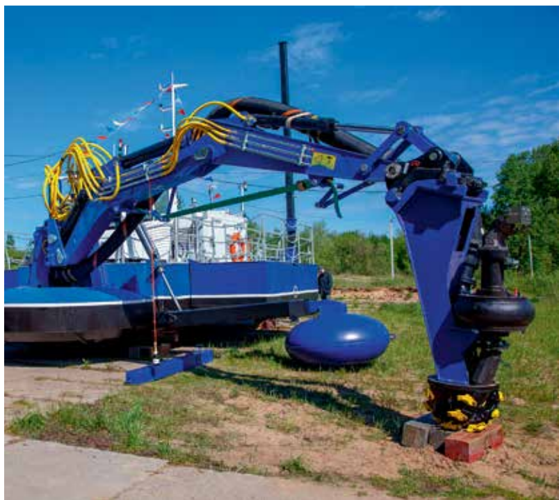
Сменное оборудование земснаряда проекта 2040: грабли, обратные ковши и грунтовой насос с фрезой / Фото: АО «ГТЛК»
