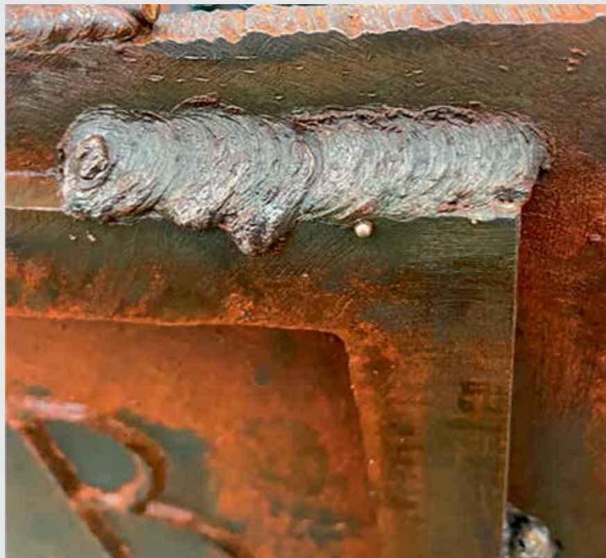
Горизонтальный шов на образце выполнен сварщиком на глубине 60 м за 15 минут / Фото: ООО «УНТЦ «Сварка»
