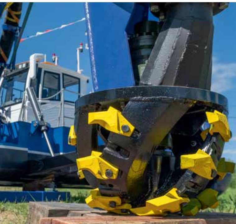
Сменное оборудование земснаряда проекта 2040: грабли, обратные ковши и грунтовой насос с фрезой / Фото: АО «ГТЛК»
