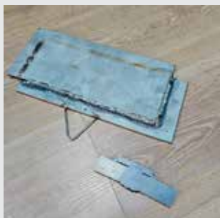
Вверху на фото – образец из хромоникелевой стали для технологических испытаний. Сварные швы выполнены в нижнем положении и в вертикальном положении: снизу-вверх и сверху-вниз. Внизу на фото – это макрошлифт сварного соединения, показывающий, что при многослойной сварке проволокой нет видимых дефектов в сварном шве
