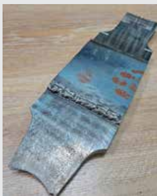
Образец для испытания сварочных материалов, которые используются при подводной сварке. Этот метод зафиксирован в правилах РМРС, а также используется Американским обществом сварщиков (AWS), как контрольное испытание для допуска сварочных материалов при подводной мокрой сварке. В нижней части данного образца произошел разрыв по элементам крепления, сварной шов тестовые нагрузки выдержал
