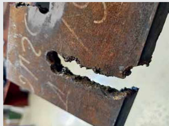
Результат резки стальной пластины толщиной 20 мм порошковой проволокой ППР-АПЛ1 / Фото: Korabel.ru
