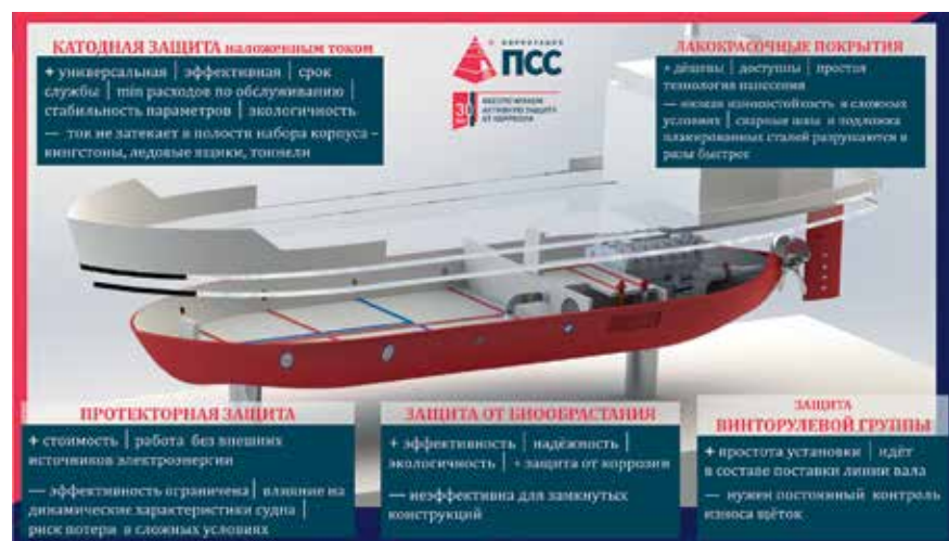
Рис.1. Алгоритм построения ЭХЗ и СЗБО | плюсы и минусы методов / АО «ППМТС "Пермснабсбыт"»
