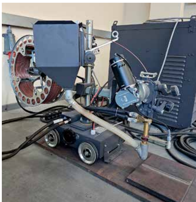
Комплекс автоматической сварки на базе оборудования российского производства. Ведется высокоскоростная цифровая съемка сварочного процесса / Фото: Korabel.ru
